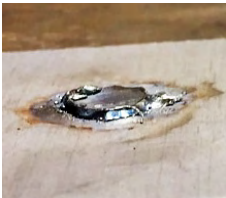
Point de soudure sur la plaque inférieure
