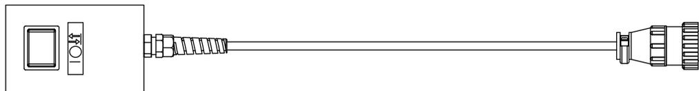
Der Fernstartschalter ermöglicht es Ihnen, den Maschinenbrenner aus der Ferne zu starten und anzuhalten. Verwenden Sie ihn beispielsweise dann, wenn Sie den Brenner an einem einfachen Schneidbrenner auf Führungswagen oder einer Schneidführung ohne eigene CNC oder andere Steuerung montieren.
