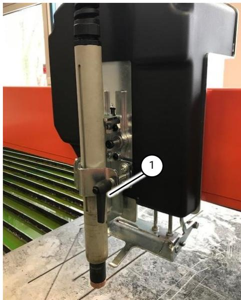
Abb. 30 Plasmabrenner am Kopf montiert
