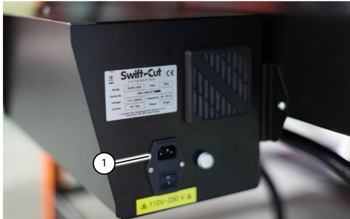
Abb. 26. Stromverbindung des Steuerungskastens
