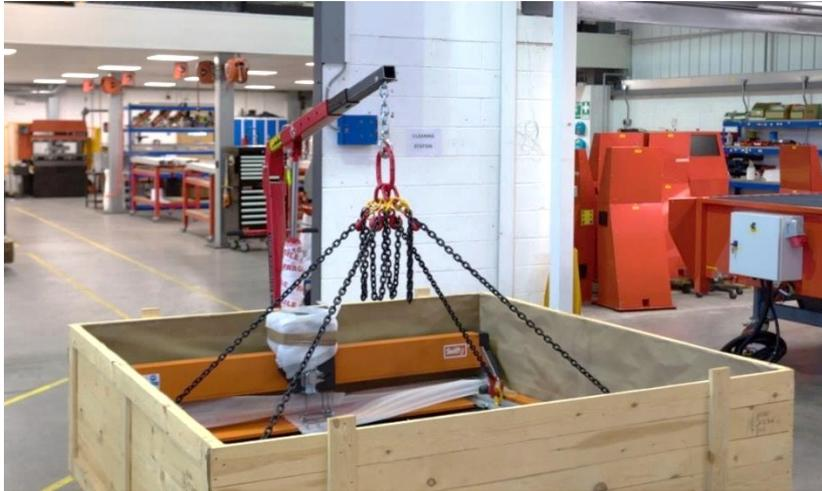
Abb. 10 Anheben mit den Hebeösen
