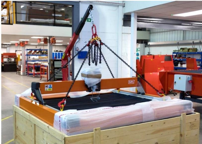
Abb. 11 Heben mit ausgerichteter Maschine.
