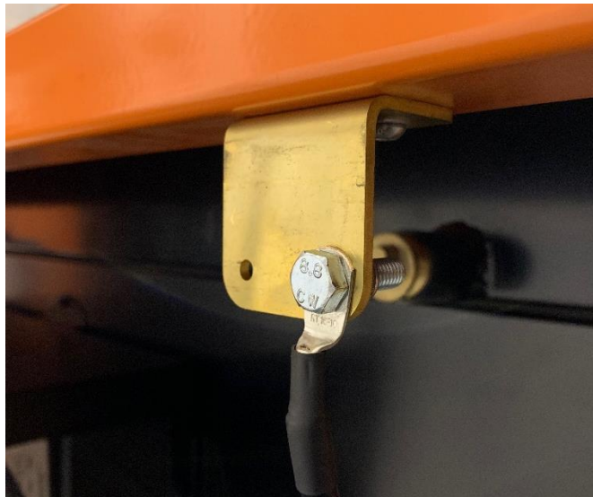
Fig 28 Câble de travail plasma fixé à la table
