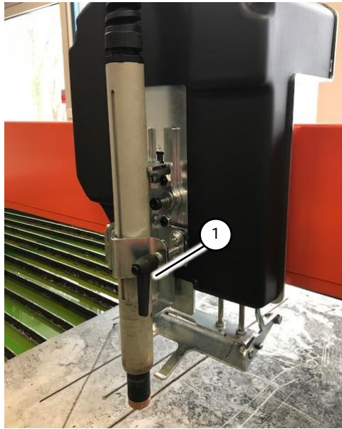
Fig 30 Chalumeau à plasma monté sur la tête
