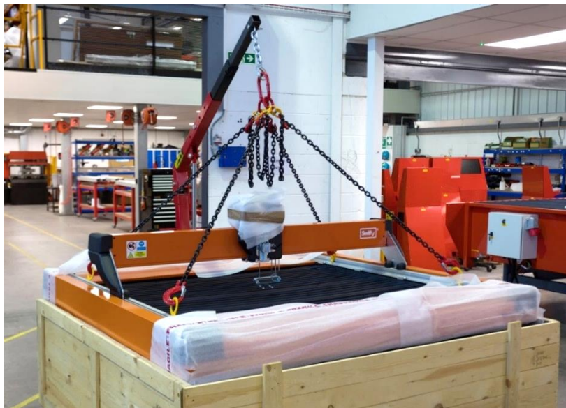
Fig 11 Levage avec le niveau de la machine
