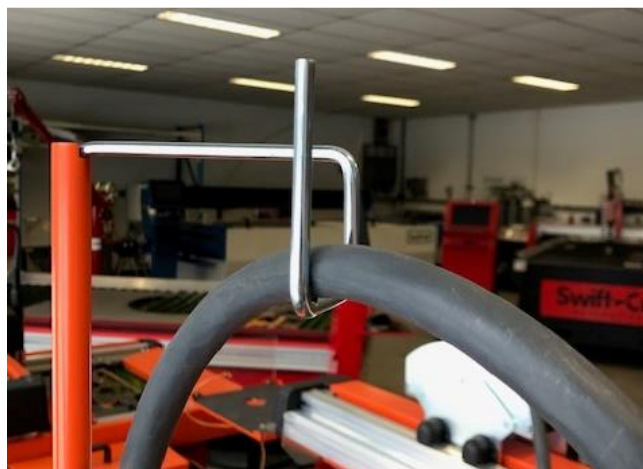
Fig 29 Câble du chalumeau sur crochet
