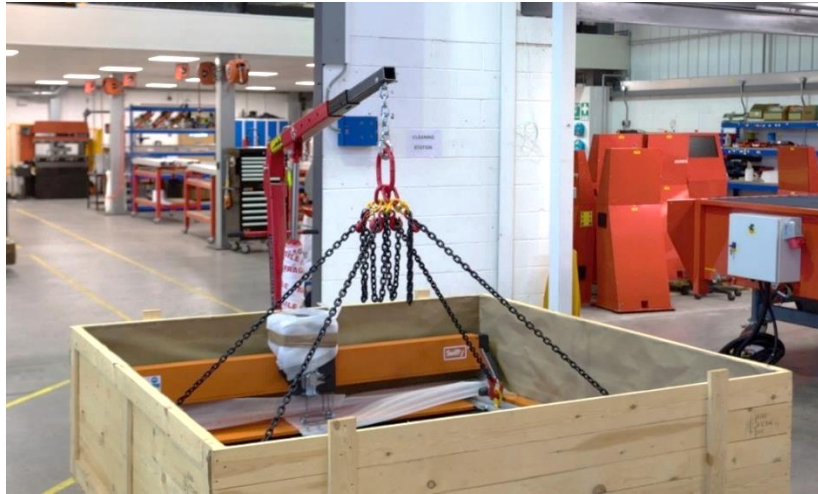
Fig 10 Levage à l'aide des œillets de levage
