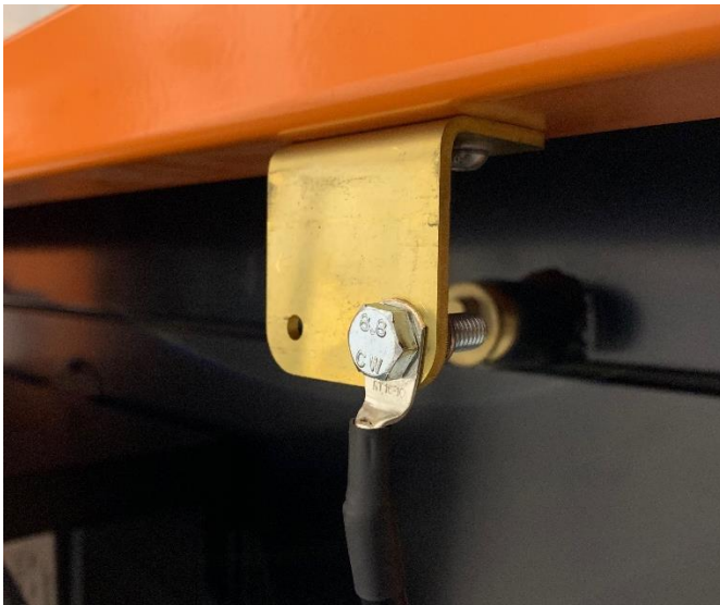
Fig. 28 Op de tafel aangesloten plasmabronkabel
