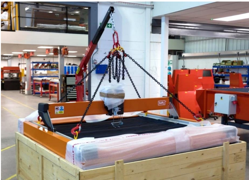
Fig. 11 Tillen terwijl de machine horizontaal hangt
