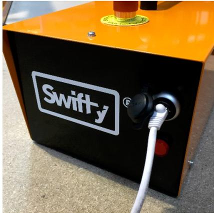
2. Conecte el cable de alimentación en la parte trasera de la caja de control.
