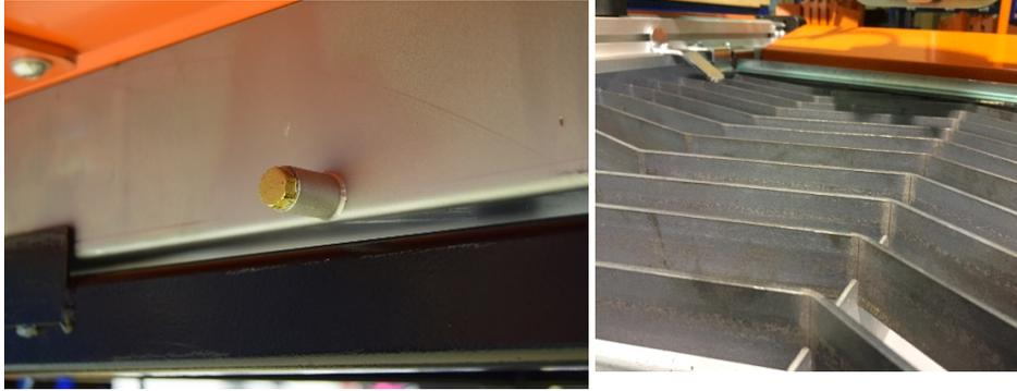
12. Acople el soporte del cable de tierra en la parte trasera de la mesa y, a continuación, coloque la abrazadera de tierra en el soporte.
